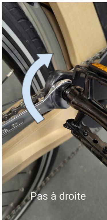
Resserrez les pédales après les premiers kilomètres parcourus. Afin de pouvoir retirer facilement les pédales par la suite, nous recommandons de graisser légèrement les pas de vis avant de les installer.
