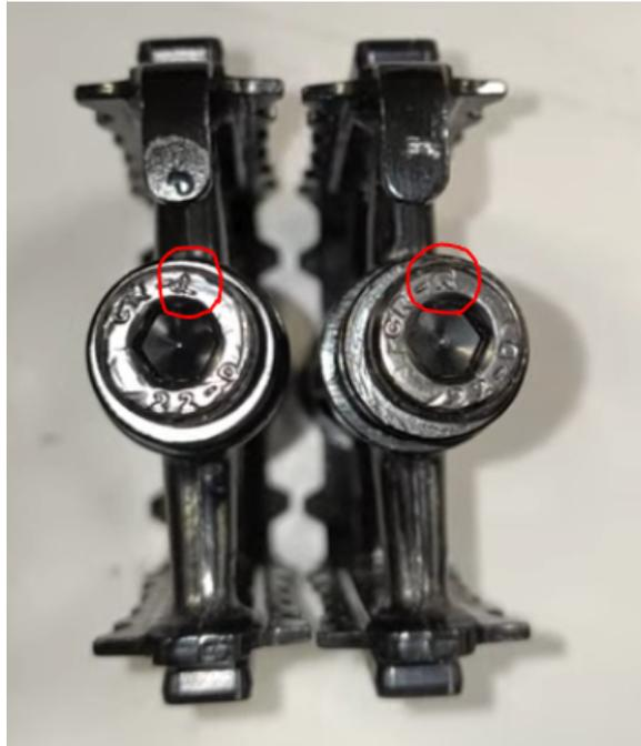
Gauche et droite sont indiqués en considérant que vous êtes assis sur le vélo. La pédale de droite se visse dans le sens des aiguilles d'une montre, comme une vis classique.
